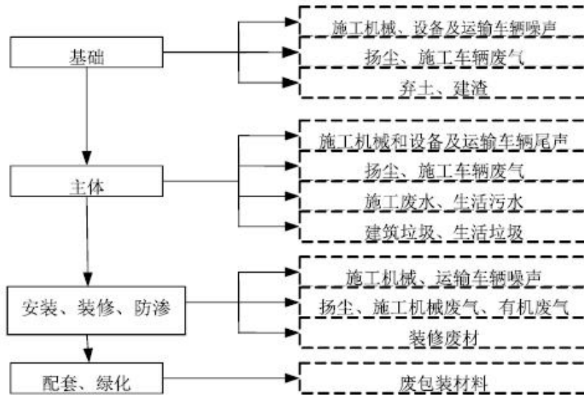
图 2-2 施工期工艺流程及产污环节图
