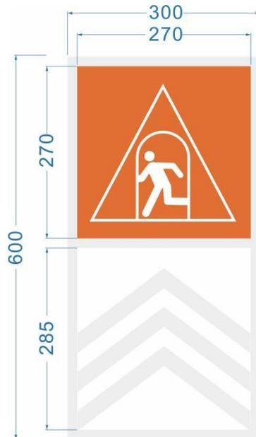
图 9 地下室地面导引标识样式及尺寸示例
