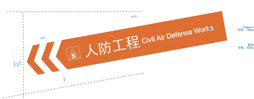
图 8 坡道出入口墙体标识样式及尺寸示例
