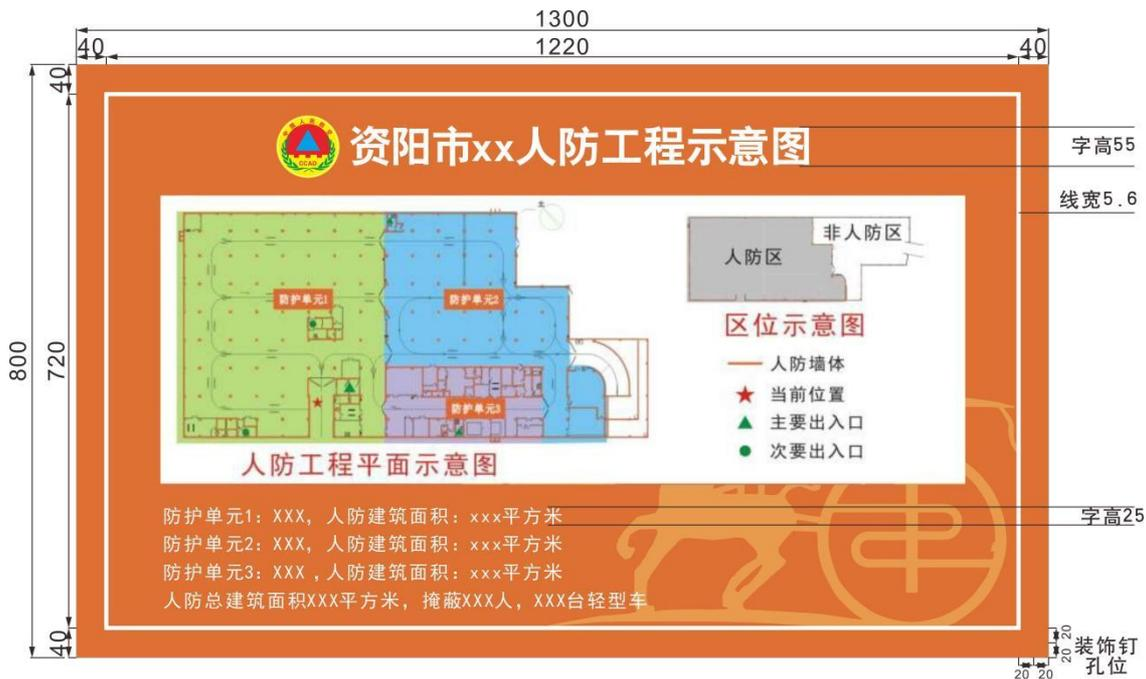
图3 《人防工程示意图》标识牌样式及尺寸示例
