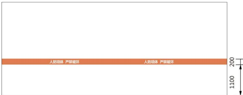
图 12 人防墙体标识样式及尺寸示例
