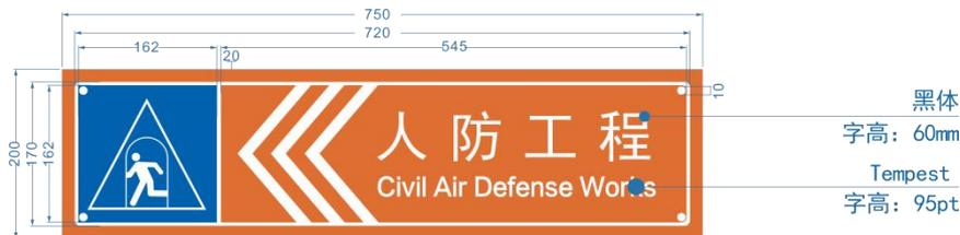
图 7 疏散指示牌样式及尺寸示例
