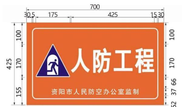
图 6 外部导引标识牌挂牌样式及尺寸示例
