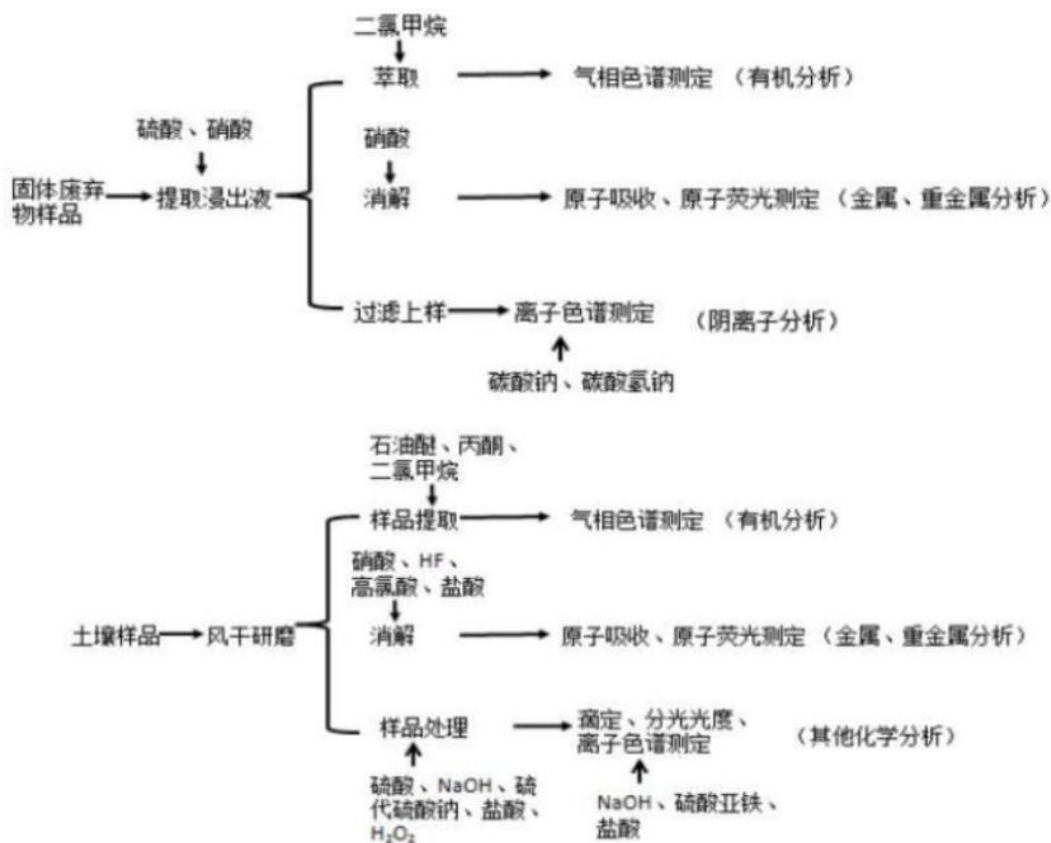
图 2-9 固态样品检测流程及产污环节图
