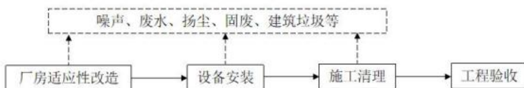
图 2-3 施工期工艺流程图
