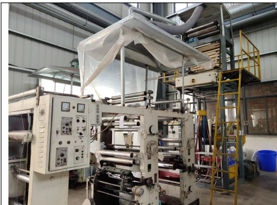
印刷机上方集气罩
