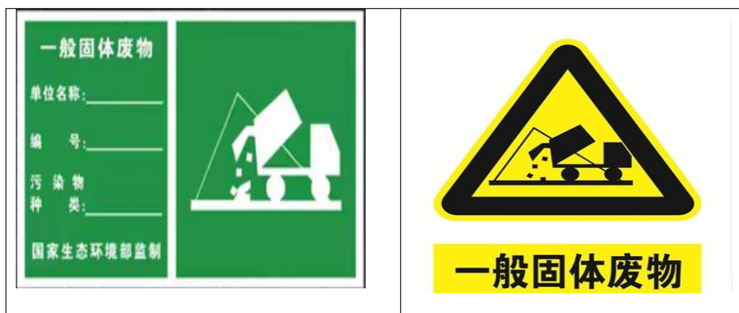
图 4-3 一般工业固体废物标识标牌示例图
