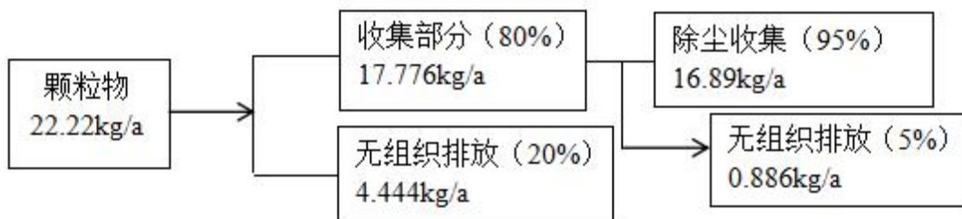
图 4-2 颗粒物废气平衡图
