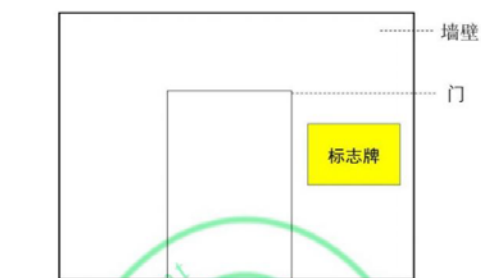
图5 附着式危险废物设施标志设置示意图
